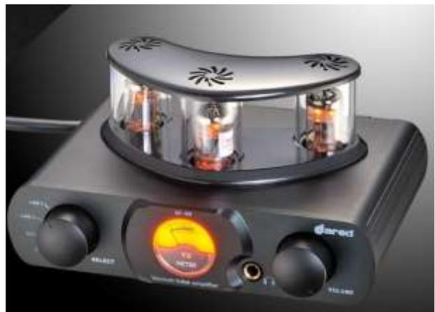
Plus original, toujours chez **Dared**, le EF-99, un préampli et amplificateur Classe A à lampes pour casque. Il dispose d'entrées stéréo analogiques RCA classiques et d'une prise USB pour récupérer de l'audio numérique, notamment provenant d'untout avec une entrée photo pour les PC. Le casque est alimenté par un fil et une prise jack à l'ancienne !
