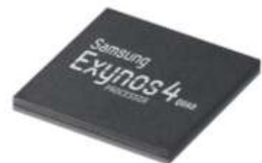
Fin 2011, Samsung avait sorti l'Exynos 4 en version 32 nm (4412) avec un double et un quadruple cœur Cortex 9 tournant à 1,4-1,5 GHz et un GPU Mali 400 MP4 supportant OpenGL ES 2.0. Il est dans le Galaxy SIII destiné au marché européen.
