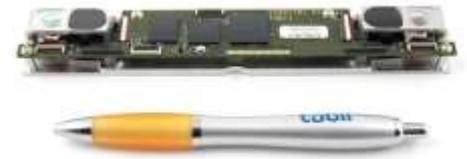
**Eyeteck** est un concurrent de Tobii qui propose son « Eye Tracking on a Chip », un chipset qui intègre toutes les fonctionnalités permettant d'ajouter le suivi de l'œil dans une tablette ou un laptop ainsi qu'un reference design. Cela permet notamment de créer des interfaces utilisateurs pour les personnes atteintes de certains handicaps dont le syndrome du canal carpien qui gêne les mains.
