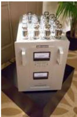
**Audio Research Reference 750**, un amplificateur à lampes de 750W. Sa puissance est délivrée par une série de 16 lampes KT120 avec une DTH (distorsion harmonique totale) de 0,5%.
