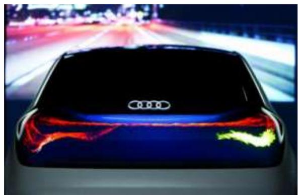
**Audi** expérimente l'usage d' OLED pour transformer l'arrière de la voiture en système d'affichage pour le conducteur suivant. Il indique notamment que le conducteur va tourner. Cela serait aussi sympa d'avoir un système qui demande au conducteur suivant de bien garder ses distances sur autoroute. Certains sont vraiment pénibles !
