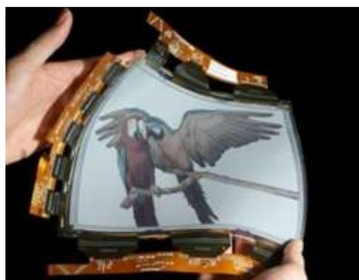
fraîchissement de 12 images par seconde. Il s'appuie en fait sur un écran e-ink et une matrice active à transistors polymères flexible (la spécialité de Plastic Logic). 12 fps c'est bien mais pas assez pour de la vidéo !
