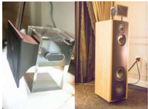
Ces enceintes du californien **ENIGMAcoustic** introduites au CES 2013 utilisent un SBESL (Self Biased ElectroStatic Loudspeaker), un tweeter électrostatique particulier qui révolutionnerait la reproduction des aigus.
