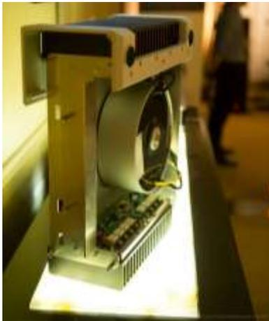
Enorme étage de puissance avec un gros transformateur toroidal vu chez **T+A**, un constructeur allemand
