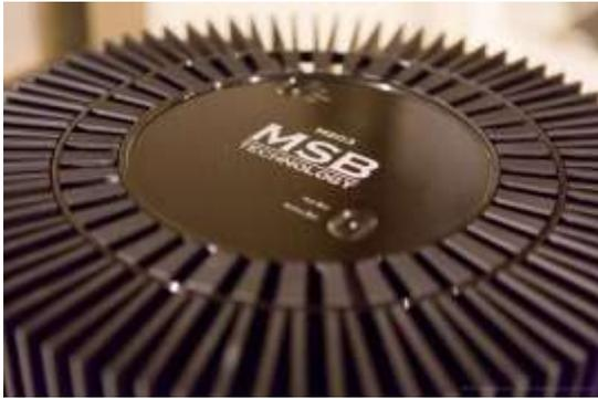
**MSB Platinum Mono 203** : un amplificateur 80 bits déjà évoqué l'année dernière qui sort 200W. Son horloge interne est précise au niveau de la femto-seconde. Il peut utiliser une source son échantillonnée à jusqu'à 384 KHz pour l'étage d'amplification (DAC). Il supporte interface I2S 384 KHz en USB et est contrôlable par smartphone.
