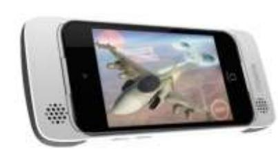
**Mophie Pulse** est une coque qui transforme un iPod Touch en console de jeu portable et y intègre dans son dos la technologie haptique Feel HD de **ViviTouch**. Il s'agit d'un vibreur composé d'un film à base de polymère électroactif qui transmet ses vibrations en faisant varier son épaisseur à basse fréquence.
